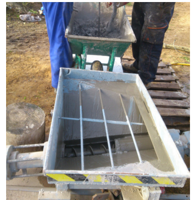
Figura 3.25: Bomba de tornillo para inyección de mortero. Nota: Esta bomba, en particular, no está homologada y carece de las medidas mínimas de seguridad exigibles, pero permite ver el mecanismo de tornillo en su interior. Fuente: los autores.
