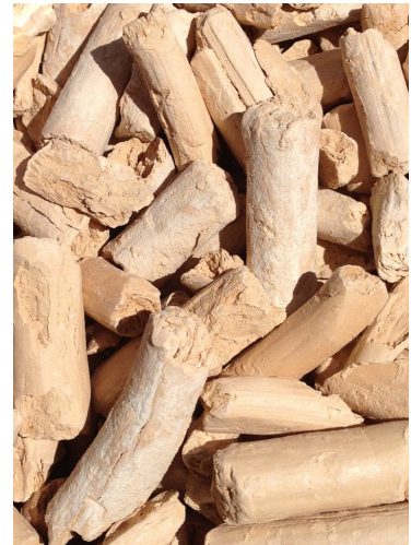
Figura 3.24: Bentonita en forma de pellets . Fuente: Steber Lester.
