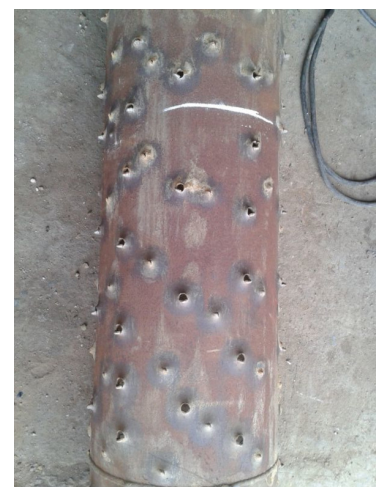
Figura 6.2: Ejemplo de tubo punzonado hidráulicamente en pruebas de laboratorio. Se aprecia la deformación de la tubería por efecto del punzón. Fuente: Los autores.
