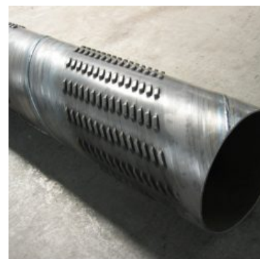
Figura 3.18: Detalle del filtro puentecillo. Fuente: THB (Taller Barragan Hermanos).
