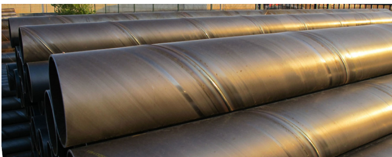
Figura 3.15: Revestimiento definitivo de gran diámetro helicoidal. Fuente: TBH (Taller Barragán Hermanos).
