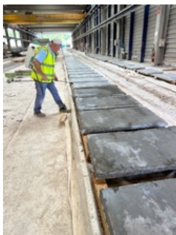
APLICACIÓN DE INNERSEAL ® EN PRELOSAS - ALTA DOSIFICACIÓN: 0,6 L/M2
