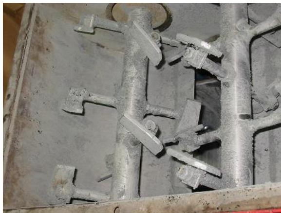
Foto 4.- Detalle de las paletas de un mezclador
