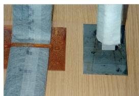
Drenes planos y circulares con placa de anclaje
