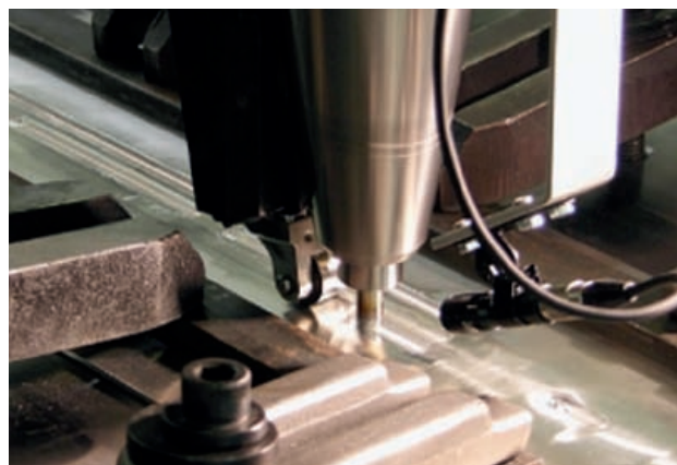
Figura 2. Detalle de equipo de soldadura por fricción (Fuente: NIAR National Institute for Aviation Research).
