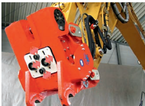
Figura 3. Sistema hidráulico de adaptación rápida de herramientas [12].
