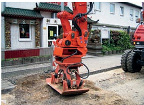
Figura 4. Sistema de compactación adaptado a brazo de máquina hidráulica [12].
