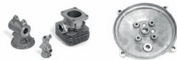
Figura 1. Piezas de aluminio fabricadas por die casting.
