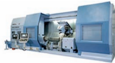
Figura 2. Centro de mecanizado con capacidad para realizar torneados, fresados y taladrados [2].
