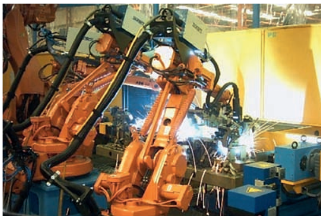
Figura 1. Estación robotizada de soldadura. (Fuente: Sunarc)
