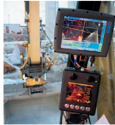
Figura 9. Avanzado sistema de control de máquina excavadora, llamado GEOROG [42].
