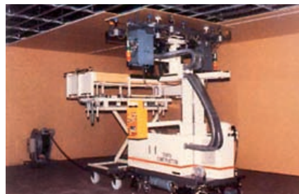
Figura 7: Robot programable para colocación de falsos techos y paneles de fachada.
