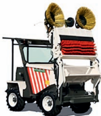
Figura 9. Dúmper barredora con posibilidad de cambio por pala cargadora.
