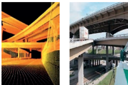
Figura 1. Escáner -D (LADER) en campo e imagen obtenida desde posición inferior.
