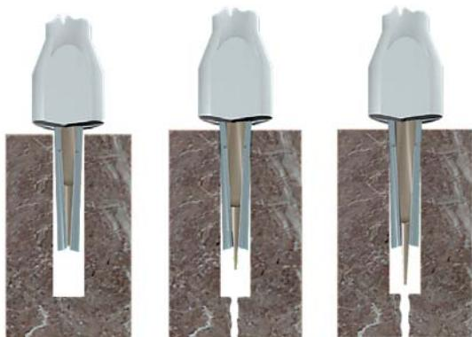
El método consiste en realizar previamente taladros de entre 31 y 48 mm. De diámetro en una profundidad desde 270 hasta 680 mm. Se introducen en los taladros los cilindros quebrantadores. En el cilindro, el pistón es impulsado hacia fuera mediante presión hidráulica y este a su vez, impulsa la cuña central, desplazando esta a las dos contra-cuñas situadas lateralmente con una fuerza de más de 400 toneladas. Esta fuerza provoca la rotura del material, que se separa en pocos segundos.
