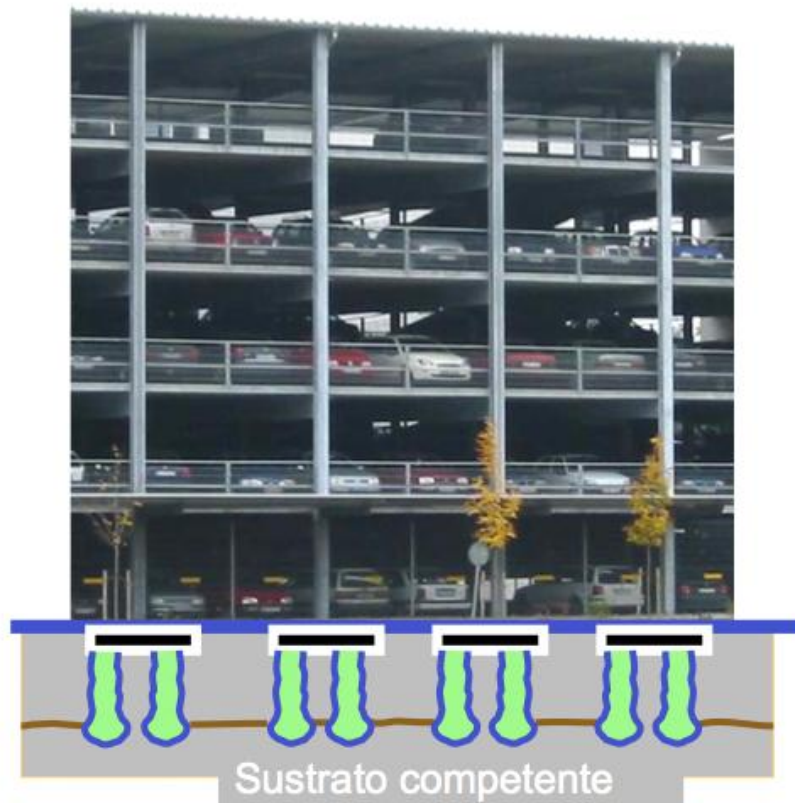
Figura 1. Sección transversal esquemática de una estructura con fundaciones con tratamiento de columnas de grava.
