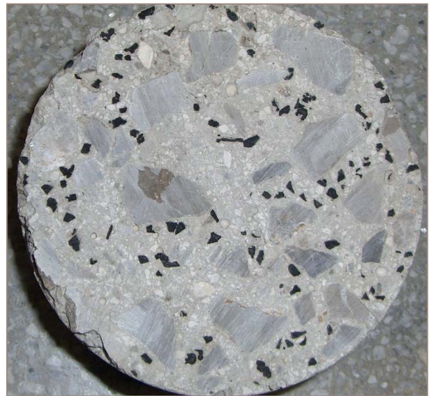
■ Figura 2. Probeta de hormigón con sustitución parcial de los áridos naturales por residuos de neumáticos. (Foto: cortesía de PREHORQUISA).
