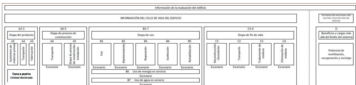
■ Figura 1. Esquema de módulos a lo largo del ciclo de vida de un edificio, según UNE-EN 15804.
