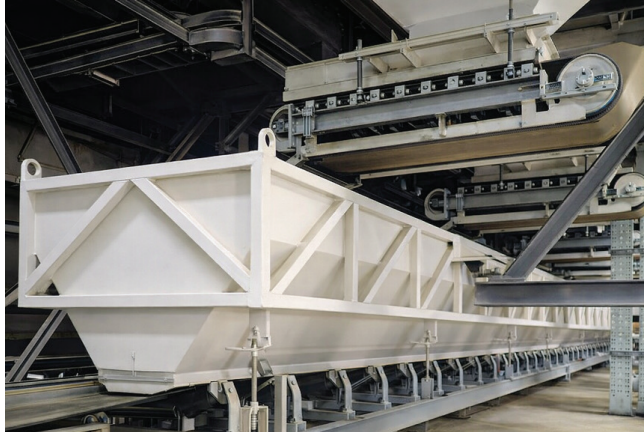
Figura 4. Dosificador volumétrico de áridos
