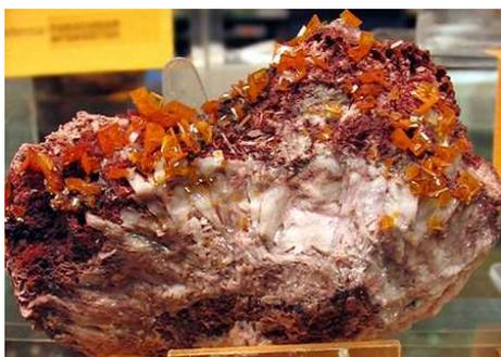
La barita es una roca de cantera compuesta de un 90 a 95% de Sulfato de bario con un peso específico de entre 4.1 y 4.3. Se puede procesar con cierta facilidad para transformarla en árido fino y grueso, y normalmente se obtiene un hormigón de densidad 3.7. En la figura 2.4 podemos apreciar una imagen del mineral de barita.
