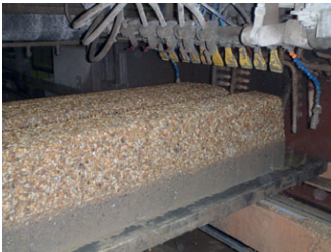
Se puso en funcionamiento una estación de lavado para la cinta transportadora con los productos frescos
