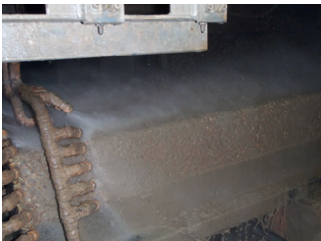
La estación de lavado permite llevar a cabo un acabado de la superficie de alta calidad
