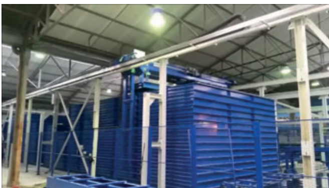
La zona de curado tiene cabida para 210 paletas de 5450 x 1250 x 220 mm
