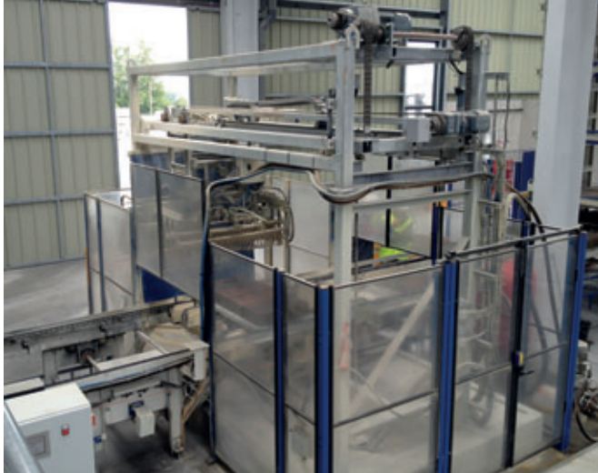
Se puso en funcionamiento una estación de lavado para la cinta transportadora con los productos frescos
