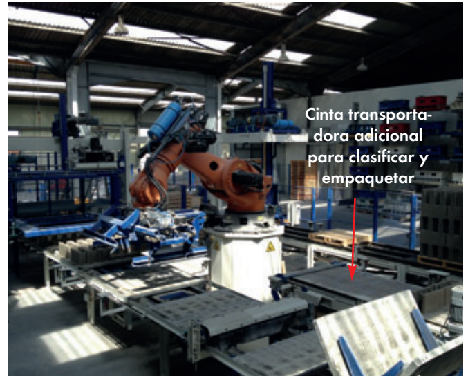
El robot de embalaje Kuka de seis ejes tiene una capacidad de carga de 1000 kg
