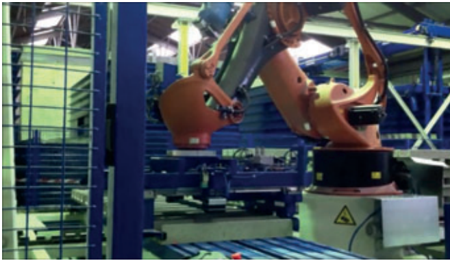
La estación de paletizado se ha equipado con un robot Kuka del tipo PA 700
