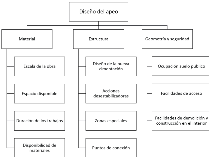
Figura 2.11. Diseño del apeo.
