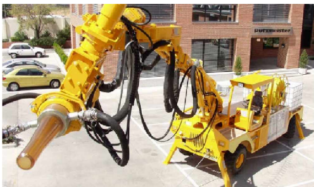
Equipos de proyección por vía húmeda y vía seca
