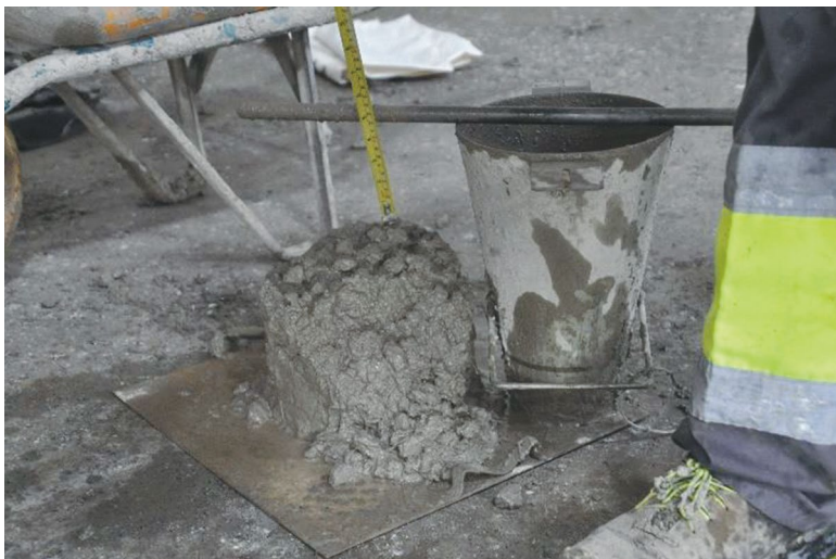
Imagen 1. Cono de Abrams para medida de la consistencia.
