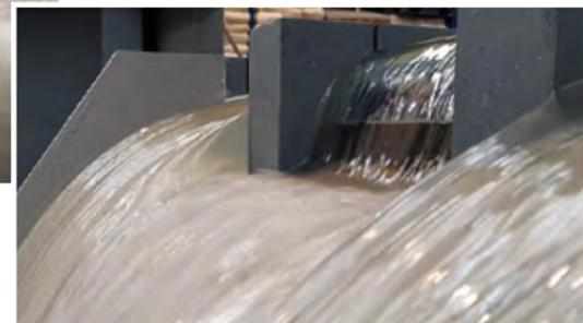
Presa y aliviadero principal visto desde aguas abajo. El resalto hidráulico se encuentra perfectamente confinado. Se detecta un cierto despegue aguas abajo de las pilas centrales, que ha conducido a mejorar la hidrodinámica de las mismas. La tabla superior de madera es un artificio para comprobar que no existe constricción al flujo provocada por las pilas levantadas.
