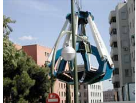
Figura 10.21. Maquinaria con cuchara y Pulpo recogedor.
