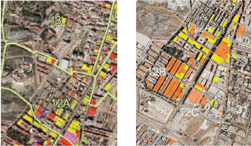
Figura 7.2. Ejemplo de sectorización y nivel de daños en la ciudad de Lorca.
