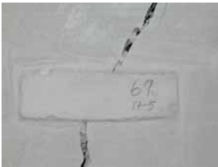
Figuras 4.19 y 4.20: Testigo de yeso y fisurómetro de metacrilato.
