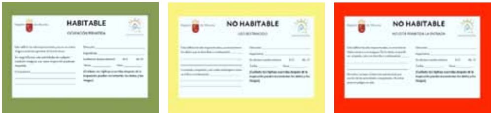
Figura 7.7. Modelo de Aviso de conclusiones de la evaluación a disponer en todos los accesos al inmueble.
