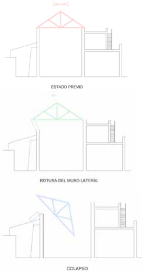
Figuras 4.15, 4.16 y 4.17: Hipótesis de colapso de la estructura de cerchas de cubierta de la Iglesia del Convento de las RRMM Clarisas, partiendo el muro de apoyo de estas en el lado más débil y donde no tiene impedidos los grados de libertad de movimiento. A la derecha, fotografías de dicho colapso.
