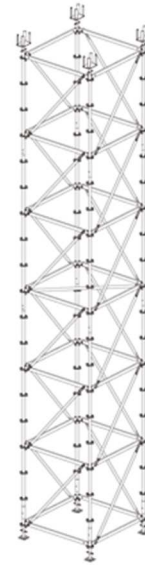
Figura 3.72. Torre de carga Fuente. Apeos y refuerzos alternativos
