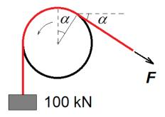
Para resolver este problema, utilizaremos la ecuación de Euler-Eytelwein del rozamiento entre polea y correa, donde  $\vartheta$  es el ángulo de contacto entre ambos. En el momento justo antes de que la polea se moviera en sentido antihorario, se tendría:
