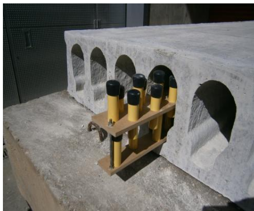
Figura 5.- Colocación de encapsulado con materiales de cambio de fase (PCM's) dentro de los alveolos de una placa, para mejora de la eficiencia energética
