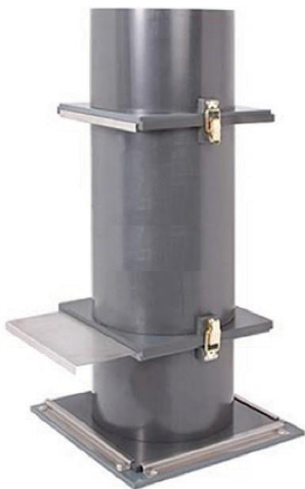
MONTAJE DEL ENSAYO DE SEGREGACIÓN ESTÁTICA SEGÚN NORMA ASTM C1610
